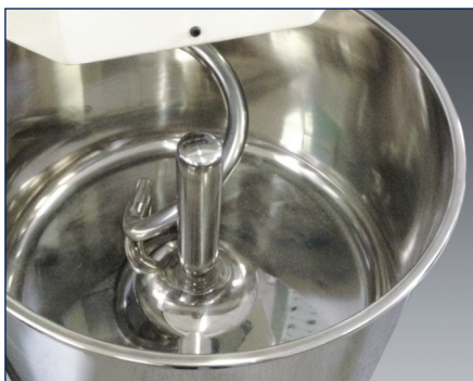
Dettaglio interno della vasca con fungo centrale per l'ossigenazione dell'impasto
